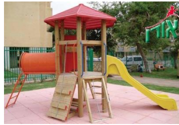
מתקן משחק מתאים לדרישות ת"י 1498. הוצב על משטח סופג אנרגיה, התקנתו בהתאם לדרישות התקן נבחנה ואושרה.
